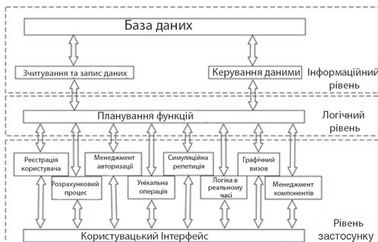
Рис. 3. Архітектура програмного забезпечення мобільного клієнта
