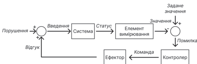
Блок-схема системи керування негативним зворотним зв'язком, що використовується для підтримання ЗП-ЗЗ
