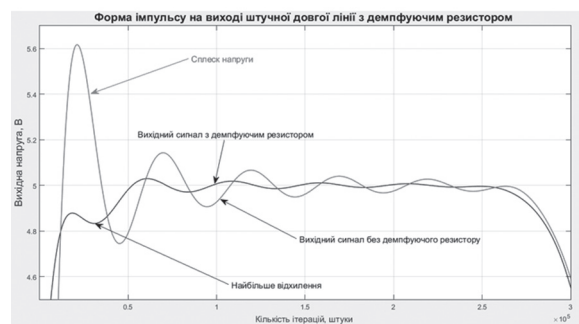
Рис. 6. Вершина імпульсу на виході штучної довгої лінії з демпфувальним резистором 1,7 R_L та ємністю першого каскаду 1,2 C у збільшеному масштабі
