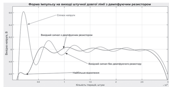
Рис. 4. Вершина імпульсу на виході штучної довгої лінії з демпфувальним резистором 1,7 R_L та ємністю першого каскаду C у збільшеному масштабі
