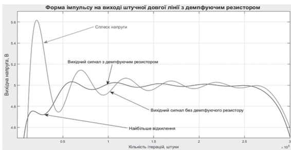
Рис. 5. Вершина імпульсу на виході штучної довгої лінії з демпфувальним резистором 1,7 R_L та ємністю першого каскаду 1,1 C у збільшеному масштабі
