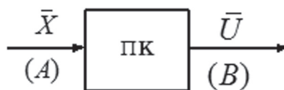
Узагальнена схема пристрою нечіткого керування
