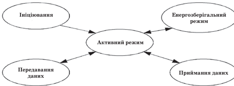
Рис. 3. Режими роботи вузла WSN
