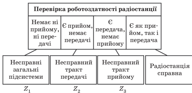
Рис. 2. Алгоритм діагностування радіостанції
