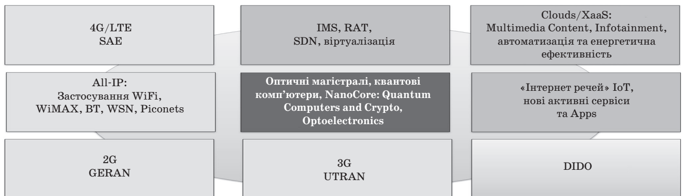
Рис. 8. Архітектура систем мобільного зв'язку покоління 5G
